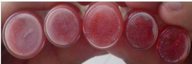
Figura 3. Nanoestructuras de ZnO precipitadas en lubricante automotriz.
